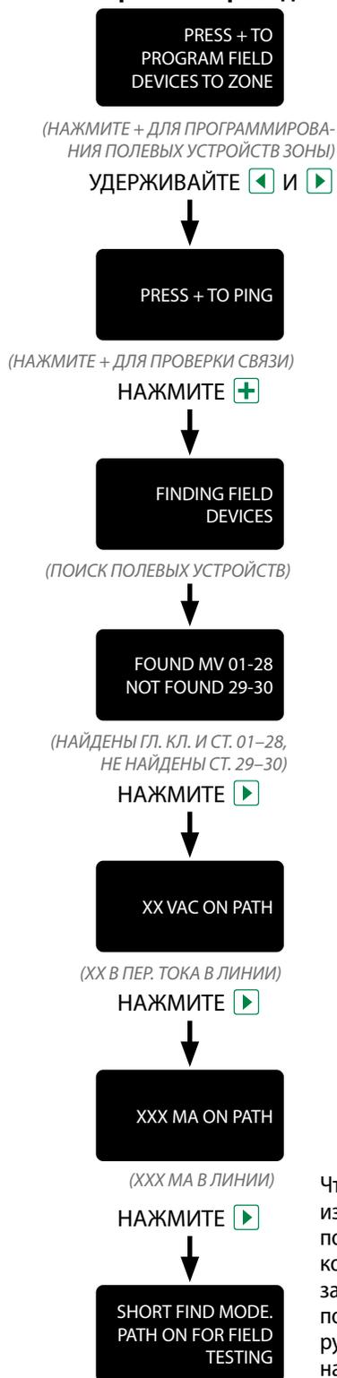
(РЕЖИМ ПОИСКА КОРОТКИХ ЗАМЫКАНИЙ. ЛИНИЯ ВКЛ. ДЛЯ ПОЛЕВЫХ ИСПЫТАНИЙ)
