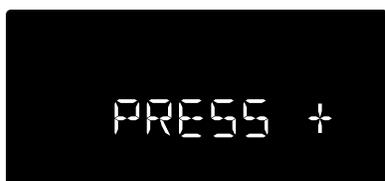
После нажатия кнопки + в 2-проводную линию подается питание и система начинает производить поиск декодеров, подключенных к 2-проводной линии, чтобы сравнить их с запрограммированными.
