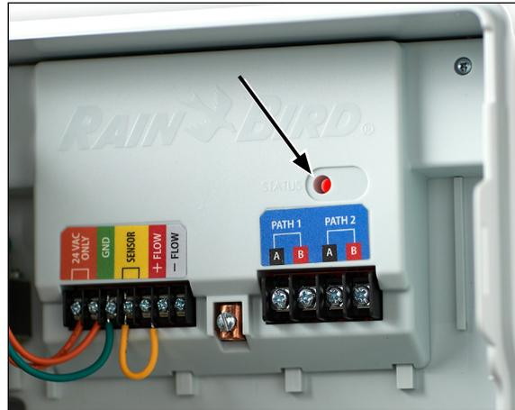
Соединительная панель контроллера ESP-2WIRE
