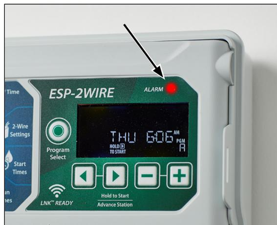
Передняя панель контроллера ESP-2WIRE
