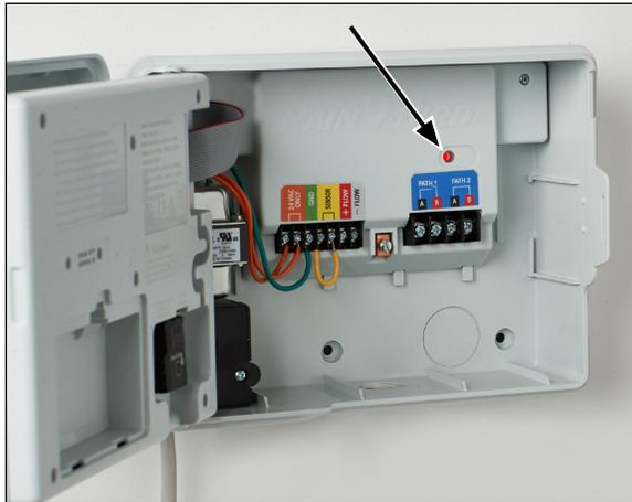
Контроллер с распашной дверцей и открытой передней панелью
