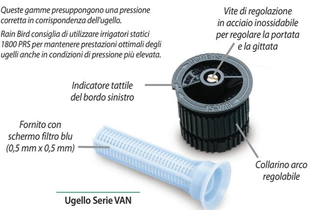
Per prestazioni ottimali, utilizzare irrigatori statici Rain Bird 1800-SAM-PRS con pressione regolata di 2,1 bar o RD1800-SAM-PRS con pressione regolata di 2,1 bar
