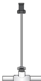
Utilizzare un raccordo a T Easy Fit e un adattatore femmina per collegare una torretta PolyFlex con gocciolatore con filettature 10-32 al tubo di gocciolamento. Aggiungere un tappo diffusore per moduli autocompensanti (PC) per eliminare gli spruzzi secondo necessità.
