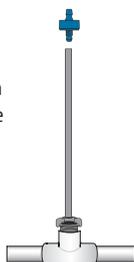
SQ può essere collegato a PE o PVC tramite un gruppo di torrette PolyFlex con un adattatore SQ ADP.
