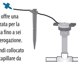
Il dispositivo Xeri-Bird™ 8 offre una posizione centralizzata per un massimo di otto gocciolatori. Usare una combinazione di gocciolatori per fornire le portate necessarie per le diverse piante. Diramazioni di tubi di capillari di 6 mm, picchetti per tubi da 6 mm e tappi di protezione insetti consentono una distribuzione precisa dell'acqua.
