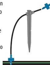
Collegare un gocciolatore con puntale (su un palo) al tubo di gocciolamento tramite un connettore a innesto e un tubo da 6 mm
