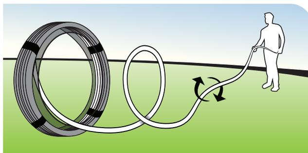
La bobina autosvolgente riduce il tempo di posa e facilita l'installazione
