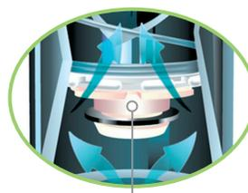
La valvola di ritenuta Seal-A-Matic™ integrata evita il drenaggio dell'irrigatore posto nel punto più basso dell'impianto, ideale nelle zone con dislivelli del terreno
