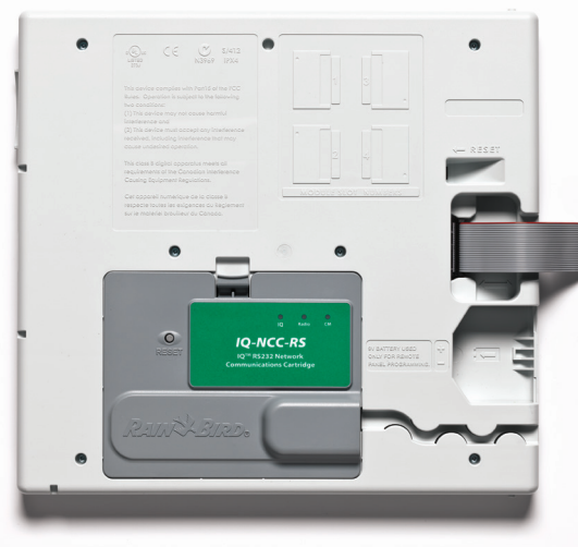
Panel del programador Serie LX con cartucho IQ-NCC-RS instalado
