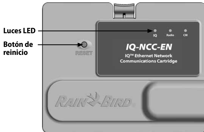
Cartucho de comunicación de red IQ (se muestra el IQ-NCC-EN)
