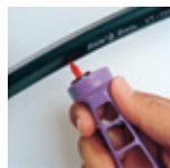
Inserção do Xeri-Bug™ num único passo
