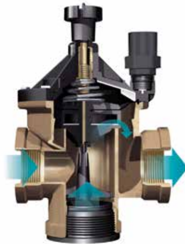
مقطع توضيحي لصمام BPES
