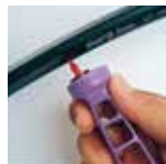
Jednokrokowa instalacja kroplowników Xeri-Bug™
