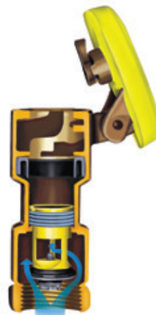
Vista transversal de una válvula de acople rápido
