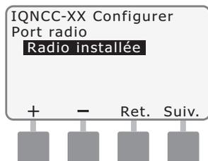
**!** **REMARQUE :** si le câble en Y est installé pour la connexion à un modem radio en communication sans fil avec d'autres satellites, sélectionnez Radio installée.
