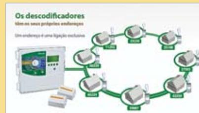
O seu programador ESP-LXD está ligado a descodificadores no campo por um canal de dois fios. Este canal transporta a corrente e informação.
