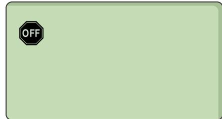
Los programas de riego permanecen almacenados en la memoria incluso cuando el controlador está apagado o si se ha perdido la corriente.
