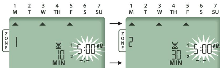
Die Startzeiten werden automatisch aneinandergereiht und sequentiell abgearbeitet, sodass jeweils immer nur eine Zone bewässert wird.
