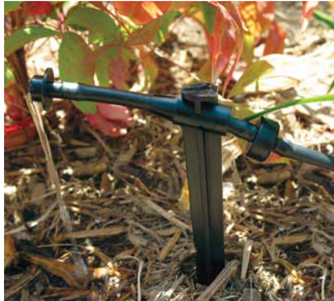
نقطة Xeri-Bug ووتد تثبيت TS025 بقطر ٤/١ بوصة وغطاء مانع الحشرات DBC025
