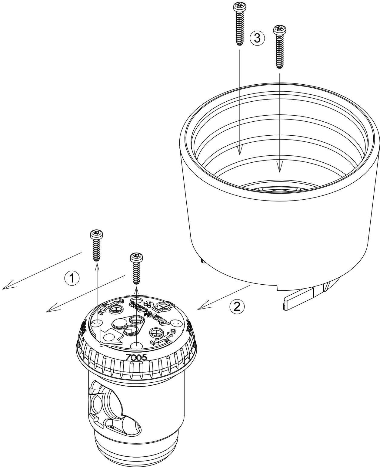
SOD CUP INSTALLATION USING TORX SCREWS
