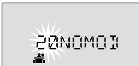
Sullo schermo viene visualizzato "20NOMOD" con il "20" lampeggiante per segnalare che la Stazione 20 (insieme alle 21-22) è inutilizzata e non disponibile per la programmazione.
