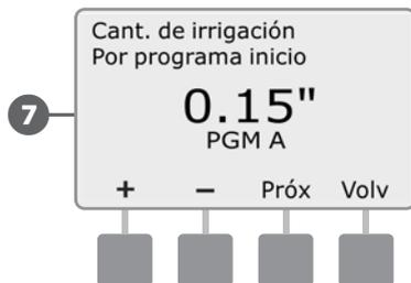
**!** **NOTA:** Los programas que usted NO quiera que reciban riego en función de la evapotranspiración (como por ejemplo la iluminación del terreno o una función para una fuente) deben establecerse en "No ET". Esto se establece presionando el botón hasta que aparezca 0.00, después se presiona el botón - una vez más para que aparezca "No ET".
