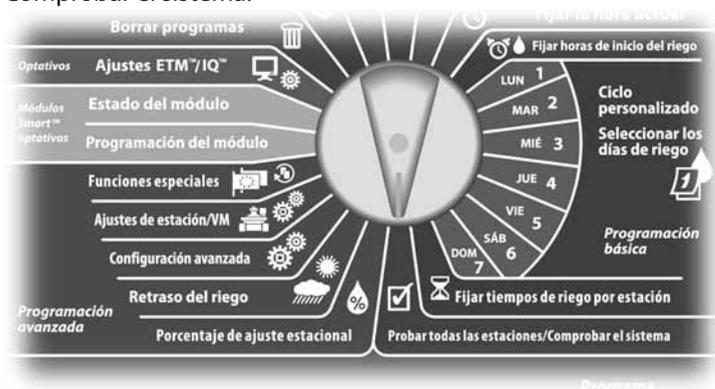
**1** Aparecerá el menú Comprobar el sistema. Pulse el botón de la flecha hacia abajo para seleccionar Probar todas estac. y, a continuación, pulse Sig.
