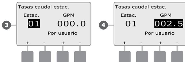
**↻** Repita este procedimiento para configurar manualmente las tasas de caudal de estaciones adicionales según desee.
