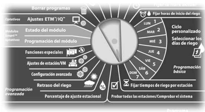
**1** Aparece la pantalla Fijar riego. Pulse los botones + y - del lado izquierdo para seleccionar la estación que vaya a programar.
