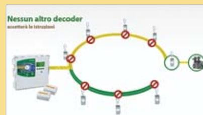
Dato che il segnale si applica solo al decoder e alla valvola con un indirizzo specifico, nessun altro decoder accetterà le istruzioni.
