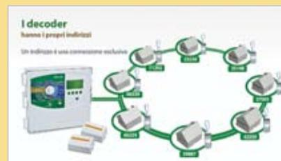
Il programmatore ESP-LXD è collegato ai decoder nel campo da un percorso monocavo. Tale percorso trasporta tensione e informazioni.
