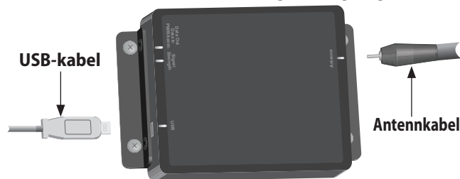
Bild 14 - Installation av ISG-2400 nätportsrouter
