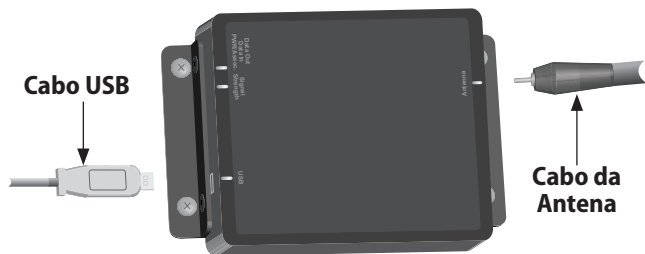
Figura 14 - Instalação do Router da Porta ISG-2400
