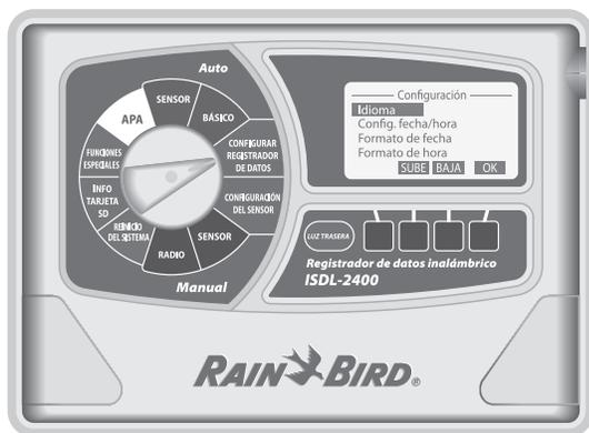
El ISDL-2400 funciona normalmente con el dial en las posiciones sensor auto (*Auto Sensor*) y básico auto (*Basic Auto*). Los datos consistentes en mediciones del suelo de los sensores e información de estado del sistema (como la dirección MAC de la radio, el voltaje de la batería y la calidad del enlace inalámbrico) se envían al software de control central (Soil Manager) a intervalos regulares.
