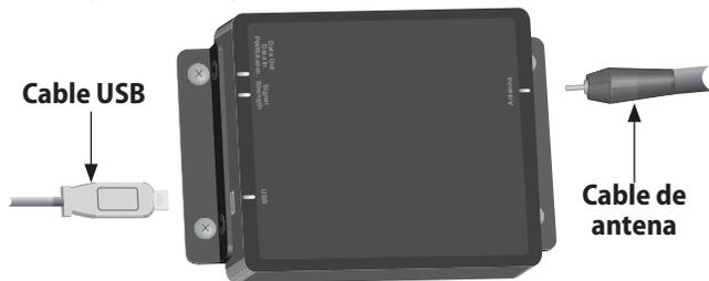
Figura 14 - Instalación del router de puerta de enlace ISG-2400
