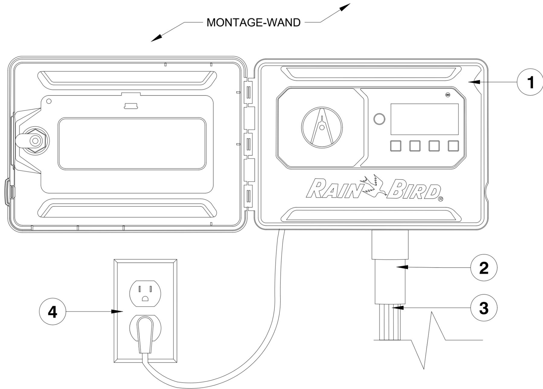
**1** ZWEIDRAHT-STEUERGERÄT: RAIN BIRD ESP-2WIRE ZUR WANDMONTAGE
