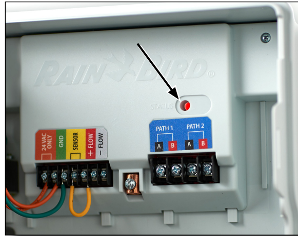
Tylny panel sterownika ESP-2WIRE
