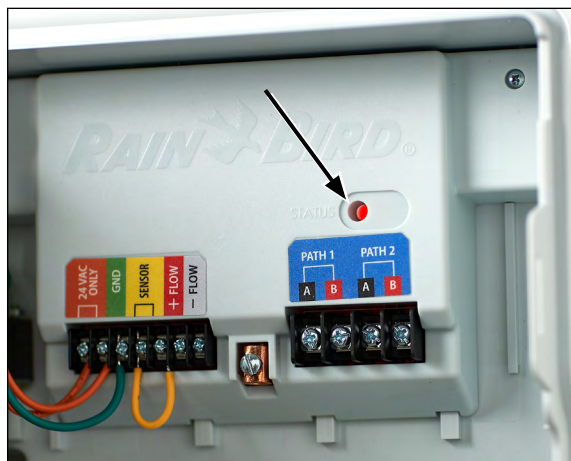
Innere Rückwand des ESP-2WIRE Steuergeräts
