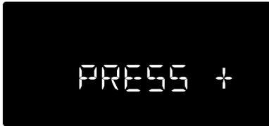
Après que vous avez appuyé sur +, le câble signal sera mis sous tension et le système commencera à rechercher les décodeurs connectés au câble signal pour les comparer à la programmation.
