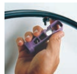
Снятие эмиттера Xeri-Bug™
