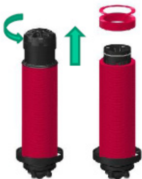
Rimozione dei dischi
