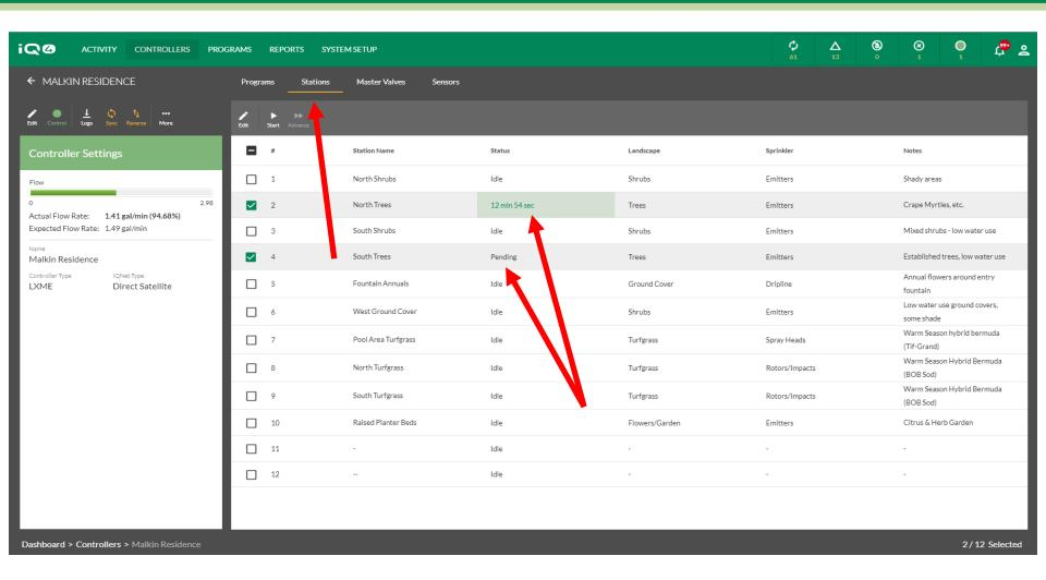
O IQ4 mostrará as estações em funcionamento e o tempo de execução restante, ou pendente, no caso de espera para colocar em funcionamento
