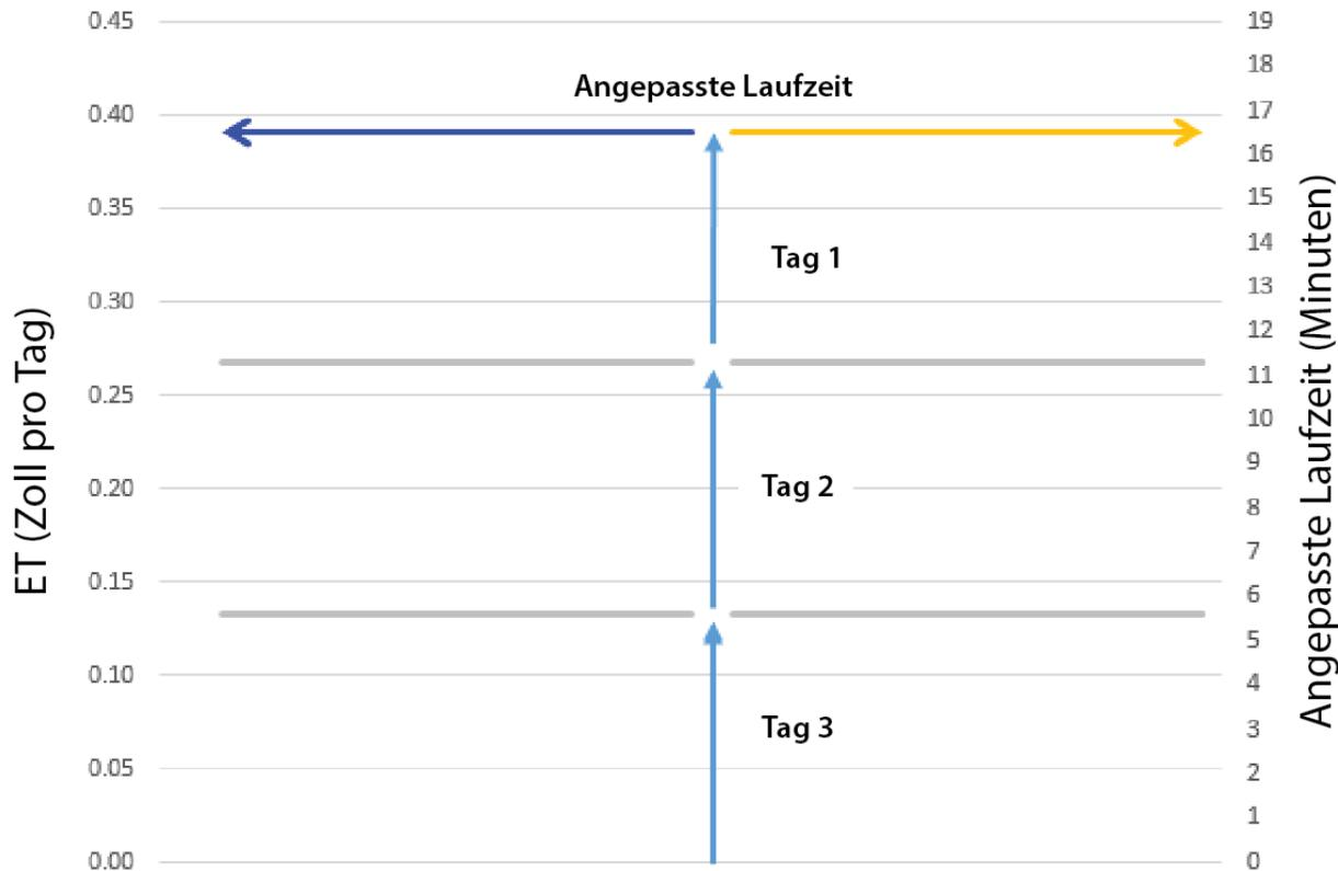
Es werden nur ausgewählte Tage ausgeführt. IQ4 rechnet die ET der ausgesetzten Tage hinzu und passt die Laufzeit an, damit die gleiche Menge an Bewässerung erfolgt
