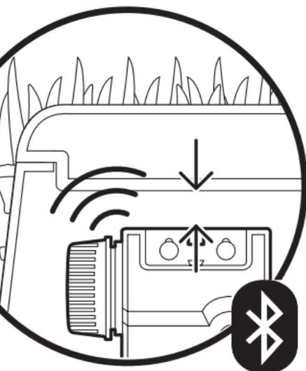
**PL:** Aby zoptymalizować zasięg i siłę sygnału Bluetooth, zainstaluj urządzenie możliwie jak najbliżej poziomemu gruntu.
