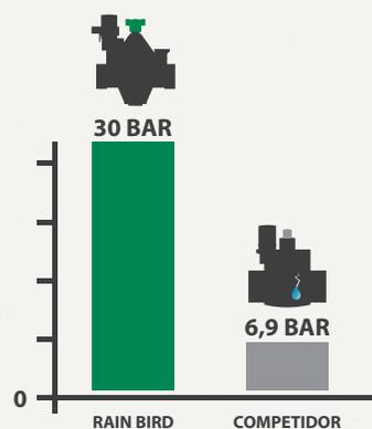
Si se produce un pico de presión del agua, usted debe estar preparado para lo peor. Para la prueba de rotura, incrementamos la presión al máximo. Hicimos lo mismo con las válvulas de otra marca. Los resultados fueron concluyentes. Mientras que la válvula de la competencia mostraba fugas entre el cuerpo y la tapa bajo presiones de sólo 100 psi (6,9 bar), la PGA no sufrió daños, incluso a 440 psi (30 bar).
