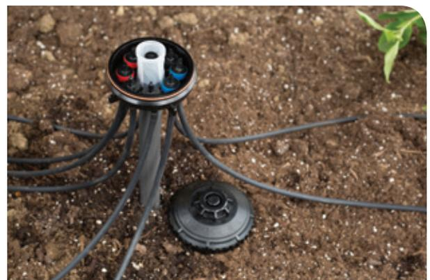
Jeder Anschluss kann durch Installieren von durchflussgeregelten Tropfern am Xeri-Bird™ unterschiedlich konfiguriert werden. Oben wird eine Kombination von 2, 4 und 8 l/h Xeri-Bug-Tropfern gezeigt.
