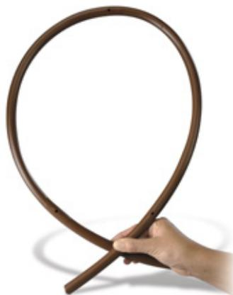
La tubería de goteo XFD ofrece una flexibilidad mejorada para la resistencia al estrangulamiento y una fácil instalación. La tubería de goteo se puede doblar hacia abajo a un radio de 7,62 cm sin torceduras.
